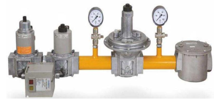
تجهیزات خط گاز اصطلاحی عمومی برای مجموعه لوازم جانبی مشعل هایی است که با سوخت گاز طبیعی کار می کنند. تجهیزات خط گاز معمولاً برای مشعل های با ظرفیت ۵۰۰۰۰۰ کیلو کالری به بالا استفاده می شود و بسته به نوع و ظرفیت مشعل، قطعات بکار رفته در خط گاز نیز ممکن است متفاوت باشد.
